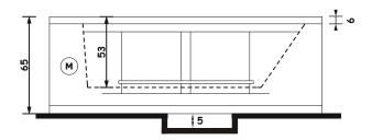
Vano ribassato per scarico sifonato | lowered compartment for siphon | profondità 5 cm | depth 5cm
